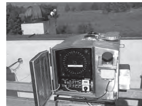
Obr. 2: Automatická bolidová kamera Astronomického ústavu AV ČR na stanici Evropské bolidové sítě v Kunžaku v jižních Čechách. Podobné kamery jsou rozmístěny na devíti dalších stanovištích v České republice a zásadní měrou přispěly k úplnému popisu velkého bolidu z neděle 4. února 2007.
